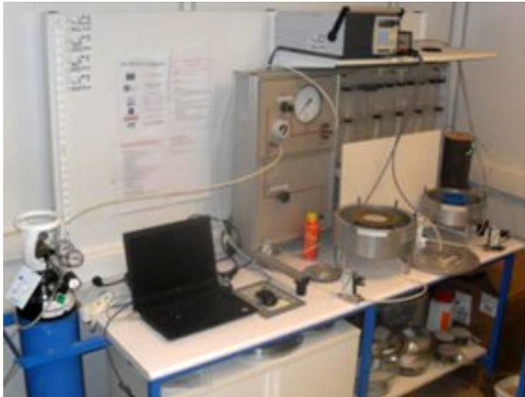
Dispositif CEMBUREAU pour la mesure de la perméabilité au gaz (Lab – GeM)
